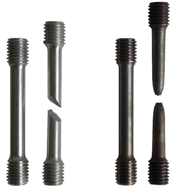
Sprödbruch (links), Verformungsbruch (rechts)
