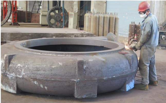
Pumpengehäuse aus beim Verputzen *
