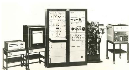
1967: MAT CH-5 DF-Massenspektrometer, für den Routineeinsatz (EB, R > 30.000 )
