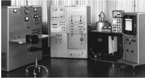
Ab 1948: erste Prototypen CH-1 bis CH-3 ( R = 300 ), 1962: CH-4 Massenspektrometer mit GC-Kopplung
