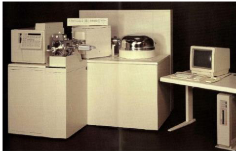
1986-2001: Start der legendären Finnigan MAT 90-Reihe. Das erste komplett computergesteuerte HRMS-Massenspektrometer!
